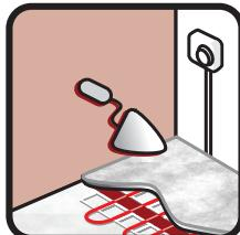
Beim Auftragen von Flex-Fleienkleber oder FlexSpachtelmasse mit einem Zahnpachtel ist darauf zu achten, dass eine Beschädigung der Heizleiterisolierung vermieden wird. Der Heizleiter muss im vollen Umfang und in der gesamten Länge voll umschlossen sein. Gegebenenfalls muss das Heizkabel nach dem Aufbringen des Klebers bzw. der Spachtelmasse leicht angehoben und dann wieder in den Fleienkleber eingedrückt werden.
